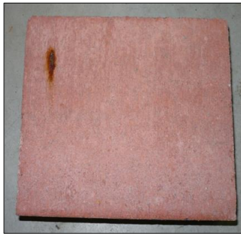
Figuur 3.16 Vlekvorming op een tegel als gevolg van de aanwezigheid van pyriet.
