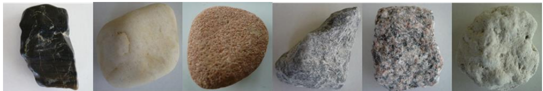
Figuur 3.12 Voorbeelden van verschillende korreltexturen: verglaasd – glad – korrelig – ruw – kristallijn - honingraat.
