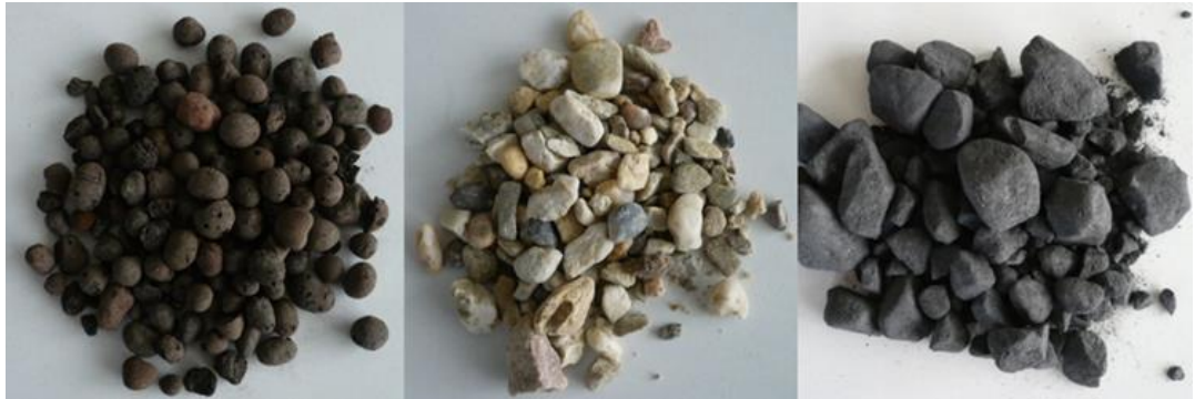
Figuur 3.4 Voorbeelden van licht (Argex), normaal (grind) en zwaar (magnetiet) toeslagmateriaal.
