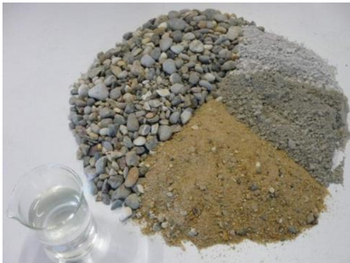
Figuur 3.1 De grondstoffen voor beton bestaan op het water, vloeibare hulpstoffen en pigmenten na allemaal uit korrels,.
